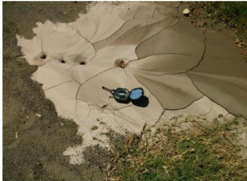
Gambar 5 Kenampakan Likuifaksi Tipe Sand Boil Akibat Kejadian Gempa Lombok Utara Tanggal 5 Agustus 2018 Di Kecamatan Kayangan, Kabupaten Lombok Utara (Sumber: Tim Pusat Studi Gempa Nasional., 2018)
