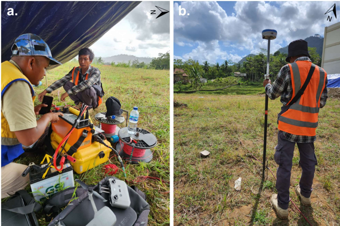
Gambar 5. Dokumentasi pengambilan data di lapangan: (a) Pengambilan data resistivitas dengan resistivitymeter ARES 5A; (b) Marking elektroda dengan GPS geodetik mobile.
